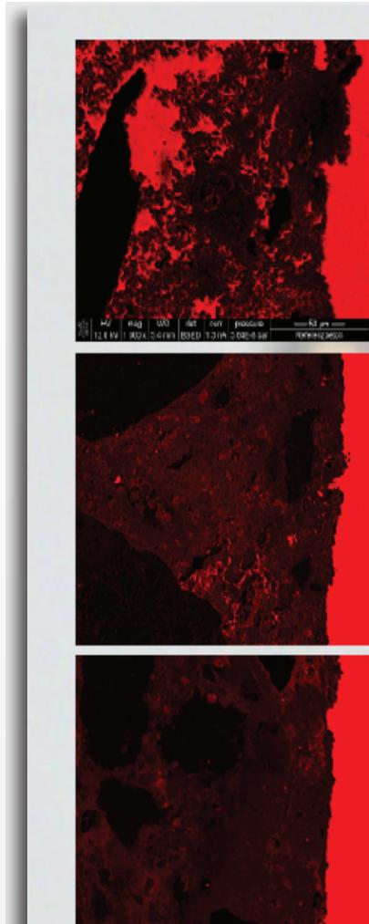
Arriba: concreto no tratado: La penetración de la resina indica la porosidad original de la pasta de cemento que se puede relacionar a la permeabilidad de la pasta.
